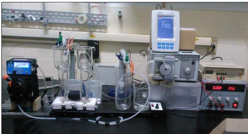
Figure 3 – Processo de eletroflotação
