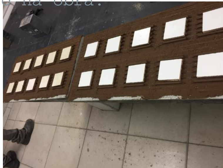
Argamassa colante feita com pozzolana e areia
