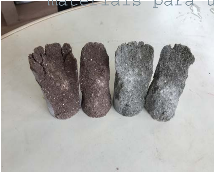
Argamassa de assentamento dos blocos feita com pozzolana e
