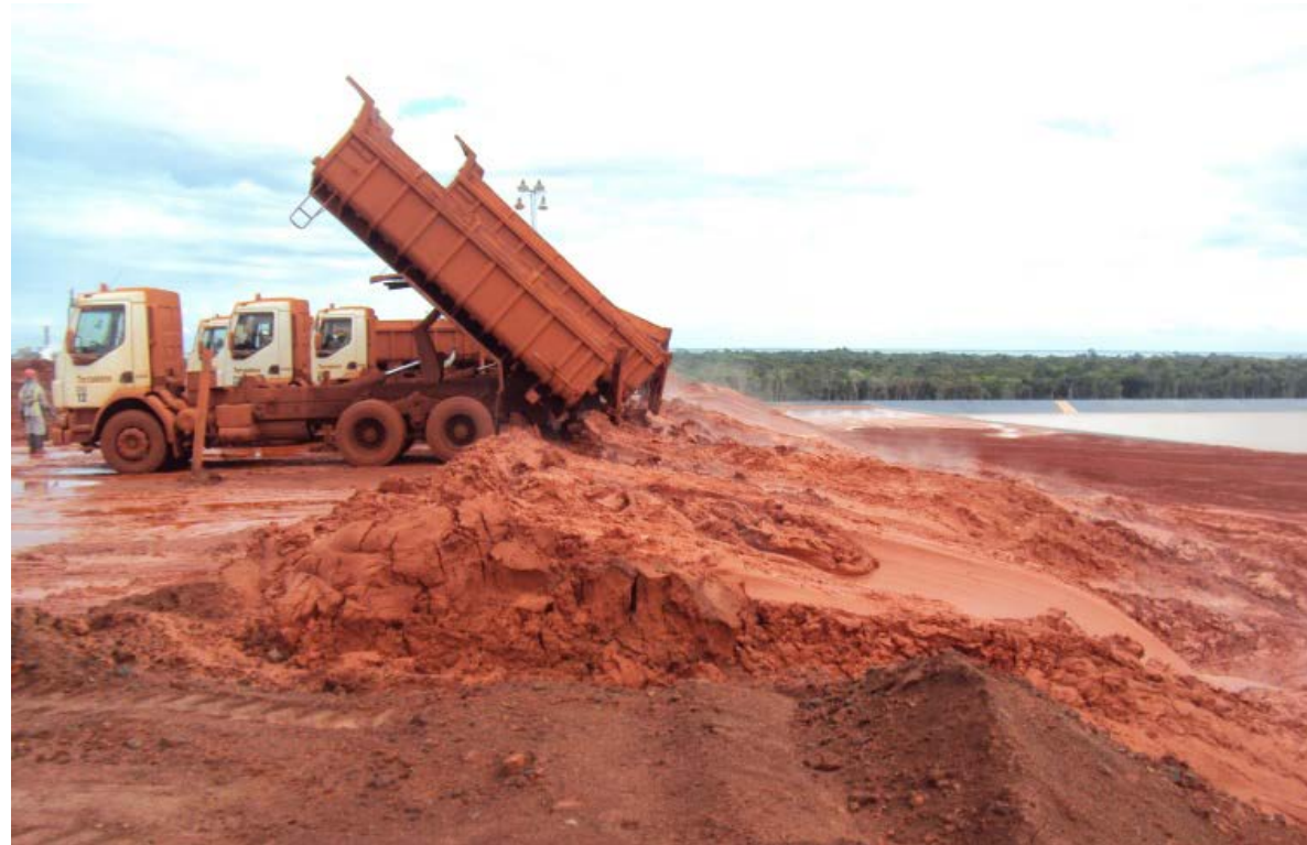
Empilhamento de resíduos ( red mud ) com elevado teor de sólidos ( Dry Stacking )
