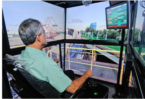
Simulador de recuperadora de roda de caçambas. A tecnologia reproduz, em ambiente 3D e de forma detalhada, o processo de recuperação dos granéis sólidos.
