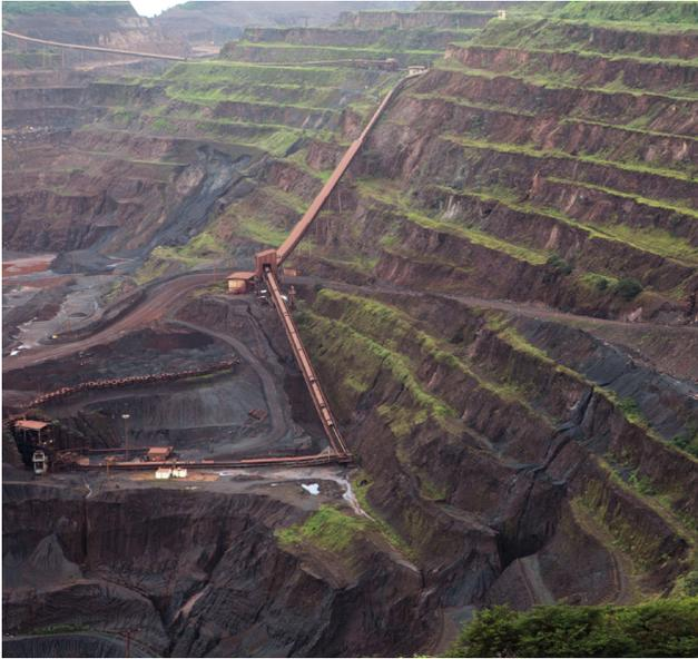
Os métodos de lavra a céu aberto são classificados em dois grupos: mecânicos e hidráulicos. No primeiro, são usados equipamentos mecânicos nas operações de lavra por bancadas e por tiras. O processo mecânico é o mais frequente na exploração de minérios, como o ferro, o carvão, a bauxita e o caulim. As pedreiras produtoras de brita e as de rochas ornamentais, como o mármore, o granito e a ardósia, também utilizam métodos mecânicos.
