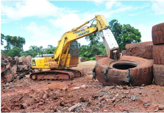
Tesoura hidráulica adaptada a escavadeira para cortar pneus, agilizando o processo de reciclagem dos pneus.
