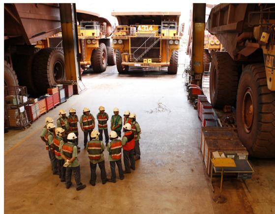
A cada intervalo de 500 horas de operação, a máquina precisa ir para os boxes para a revisão.
