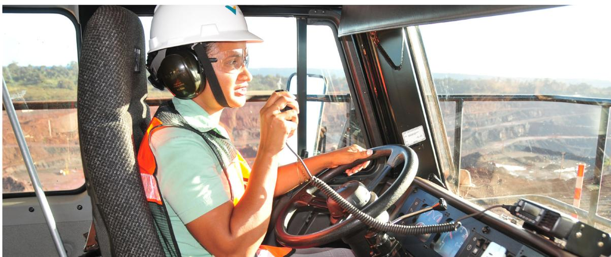
O simulador de caminhão fora de estrada é usado no treinamento dos motoristas que trafegam nas minas exploradas pela Vale.
