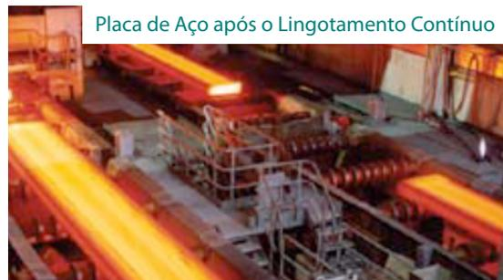
Placa de Aço após o Lingotamento Contínuo
