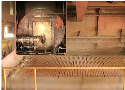
Grelha de um forno de pelotização ( No detalhe, uma câmara de combustão)
