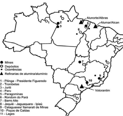
Figura 1 Minas, depósitos e refinarias de alumina e de alumínio no Brasil (Fonte: HAYSTON, 2012)
