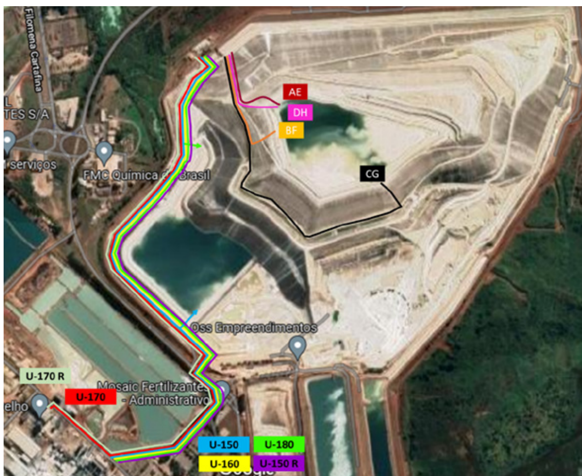
Figura 2: Vista aérea da pilha de gesso e linhas existentes de bombeamento de gesso (Mosaic Fertilizantes)
