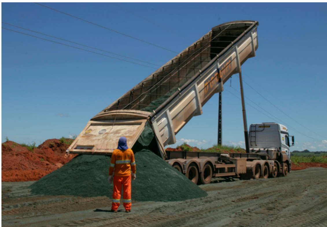
Figura 4: Transporte do coproduto para teste de larga escala pela Ecovias do Araguaia
