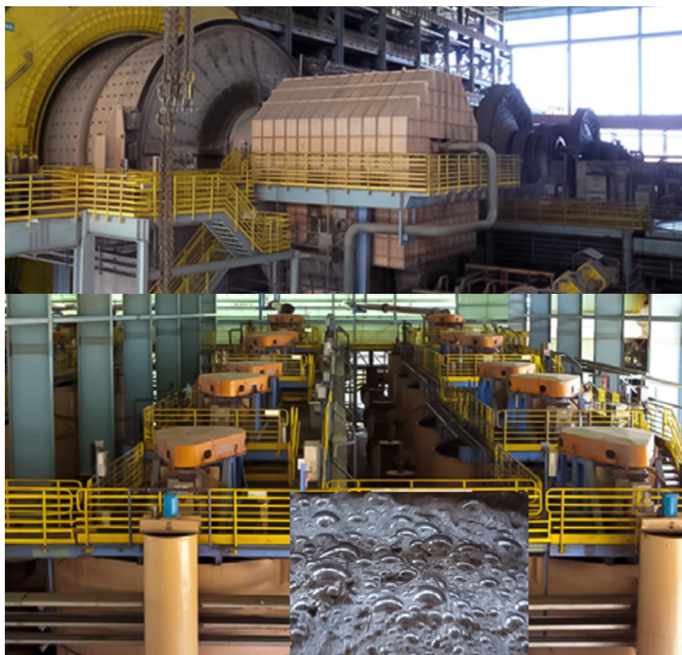
Figura 15: Operações de moagem (à esquerda) e flotação de minérios de ouro (à direita), com detalhe para a espuma mineralizada. Fonte: Kinross.
