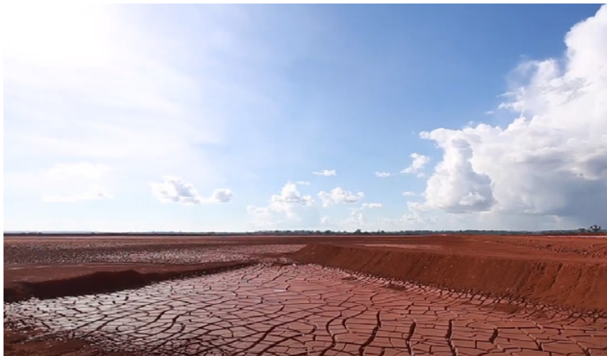
Figura 65: Método de Secagem para disposição de rejeitos finos. Fonte: YouTube, 2021.
