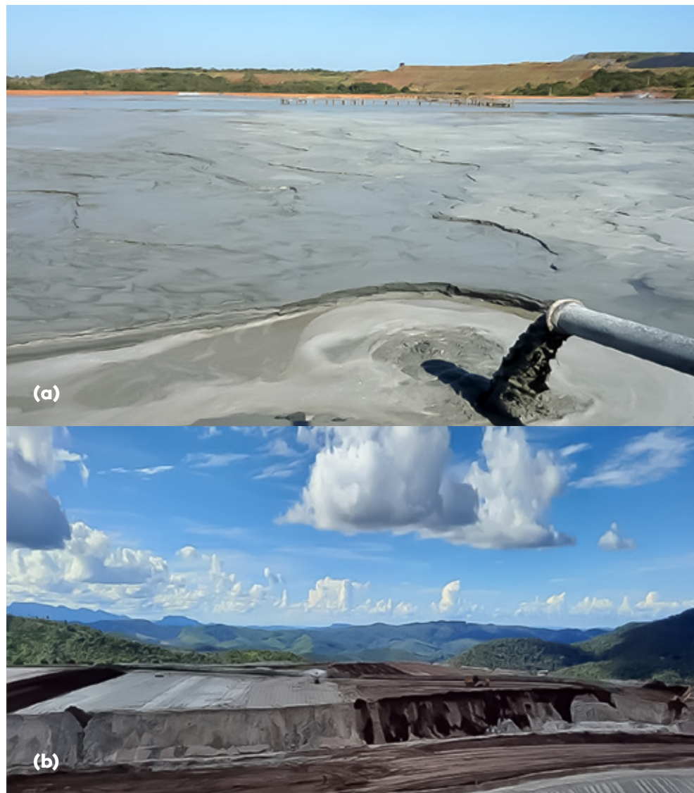
Figura 53: Disposição de rejeitos: (a) rejeito espessado de níquel sulfetado, Fortaleza de Minas-MG, 2011; (b) rejeito filtrado de minério de ferro, complexo de Itabira, MG, 2023. Fotos: Silvia França.
