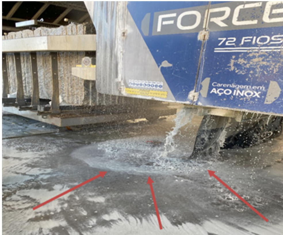
Figura 56: Canaletas para coleta de água do corte das chapas. Fotos: Ariel Wanis.
