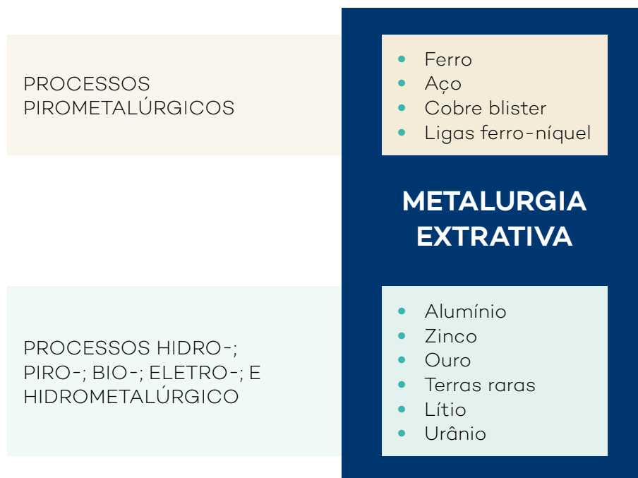
Figura 14: Exemplos de metais e ligas produzidos por diferentes abordagens utilizadas na metalurgia extrativa.
