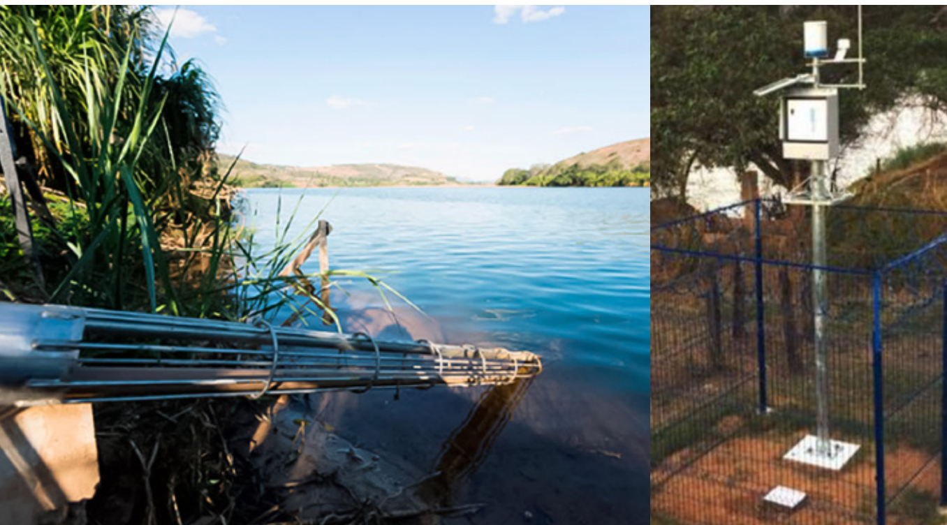
Figura 6: Exemplos de sonda multi parâmetros para monitoramento on line .
