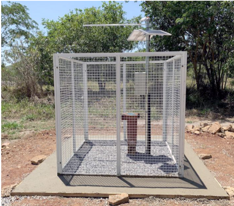
Figura 7: Exemplo de piezômetro com sistema de telemetria, com alimentação solar e comunicação por sinal satélite e celular.
