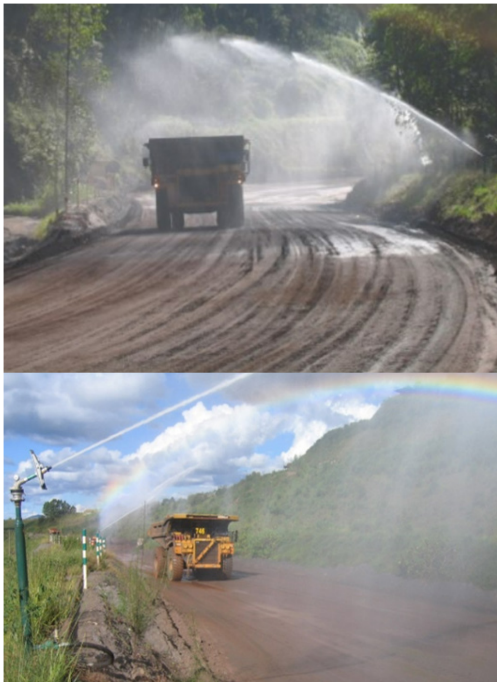
Figura 5: Exemplos de uso de aspersores on line com uso potencial de água recirculada.
