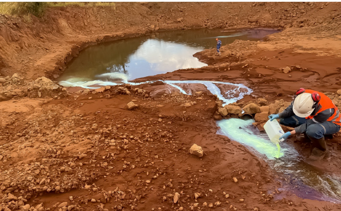
Figura 27: Foto da utilização de traçador em um ponto de infiltração de água, em mina a céu aberto.
