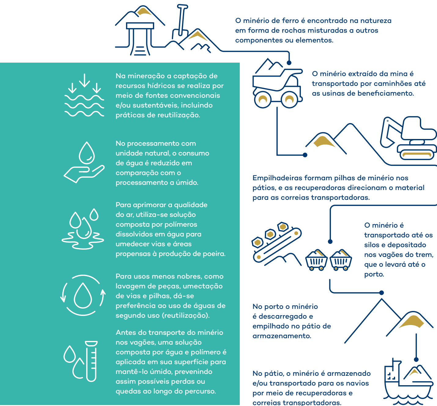
Figura 32: Esquema exemplificativo do uso da água nas diversas etapas de uma mineração de minério de ferro.
