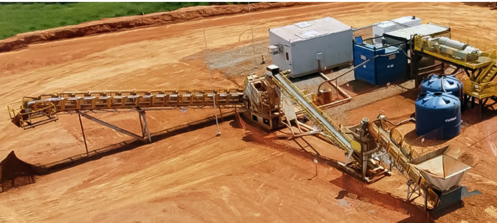
Figura 10: Unidade de beneficiamento móvel a seco (base natural). Fonte: CBA (2022).
