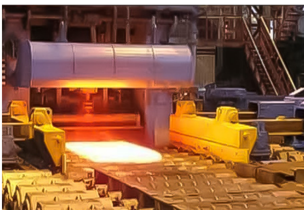
Figura 16: A produção do aço em fornos (superior) e a laminação (inferior).
