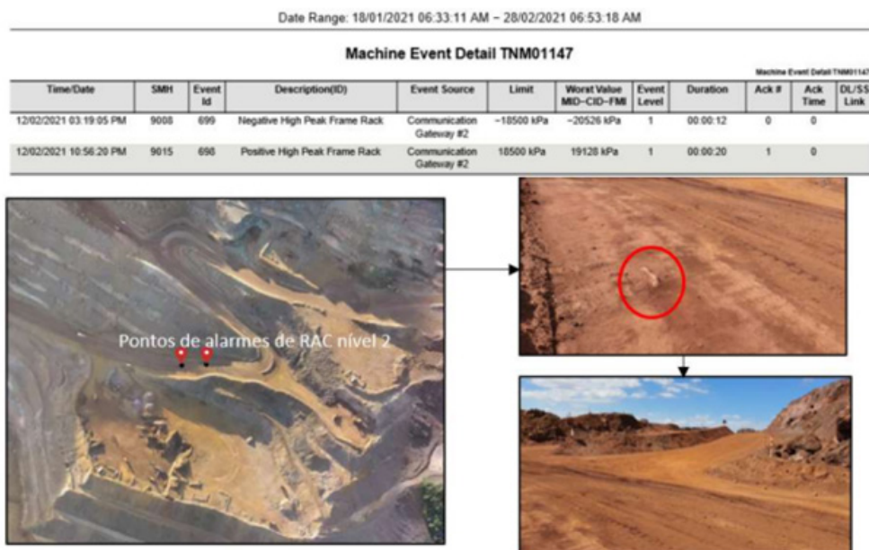
Figura 4. (i) Identificação do Alarme de RACK Monitorado pela Sotreq; (ii) Identificação da Localização do evento pela Cascadia Scientific; (iii) Correção da Via pela MUSA
